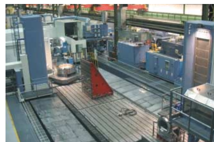
Einblick in die Fertigung: Großbearbeitungszentrum mit Werkzeugwechselroboter.
